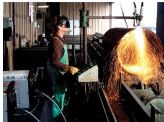
Rohr-Schneiden und Abfasen
